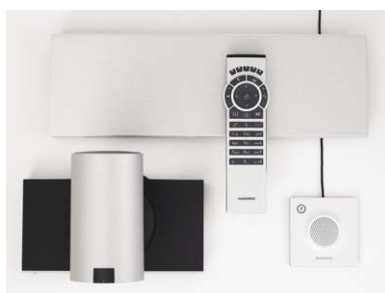
Пакет для быстрого внедрения видеосвязи Quick Set C20 содержит кодек C20, камеру PrecisionHD 1080p с 4- или 12-кратным увеличением изображения, микрофон Performance Mic 20, пульт ДУ и систему кабелей.
